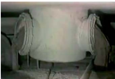
Geschmolzener und wieder erstarrter Reaktorinhalt (geringe Menge).
